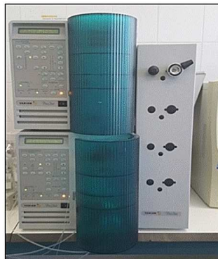
Figura 1.- Cromatógrafo de líquidos con detector ultravioleta Varian ProStar
